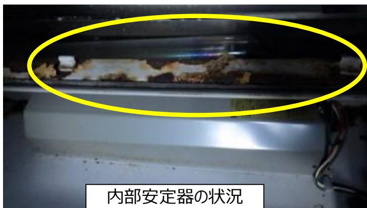
トンネルナトリウム灯（崩落寸前）
