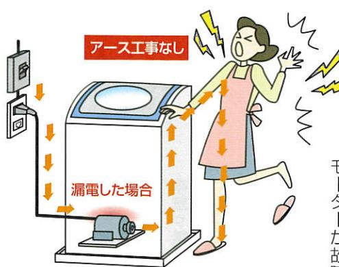
これが漏電による感電のしくみです。
