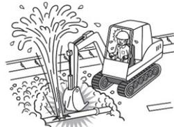
工事場内でガス管の埋設工事中、バックホーの操作をあまり、地中の水道管を破損してしまった。
